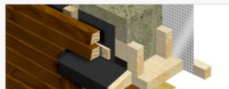
#9 Brannhemmende og UV-bestendig vindspærre →
